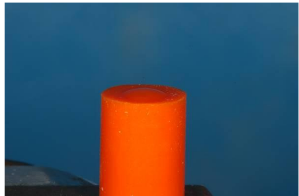
Fig. 1 Deze foto toont de buitengewoon kleine contacthoek van de waterdruppel op het washmetaal (Light Bodied). Dit toont de hydrofiele eigenschappen van Take 1 ® .
